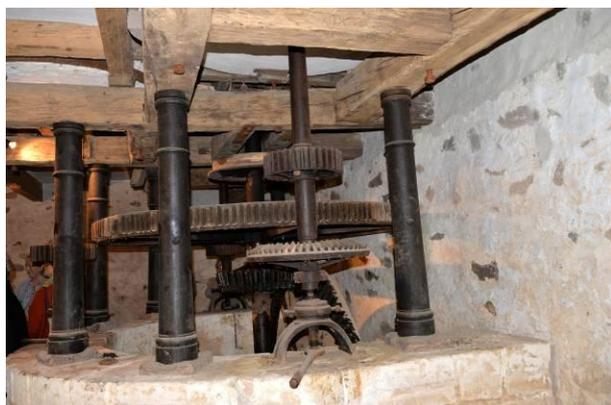
*Le mécanisme du moulin ; les colonnes sont des fûts de canons provenant probablement de la Forge à fer.*
